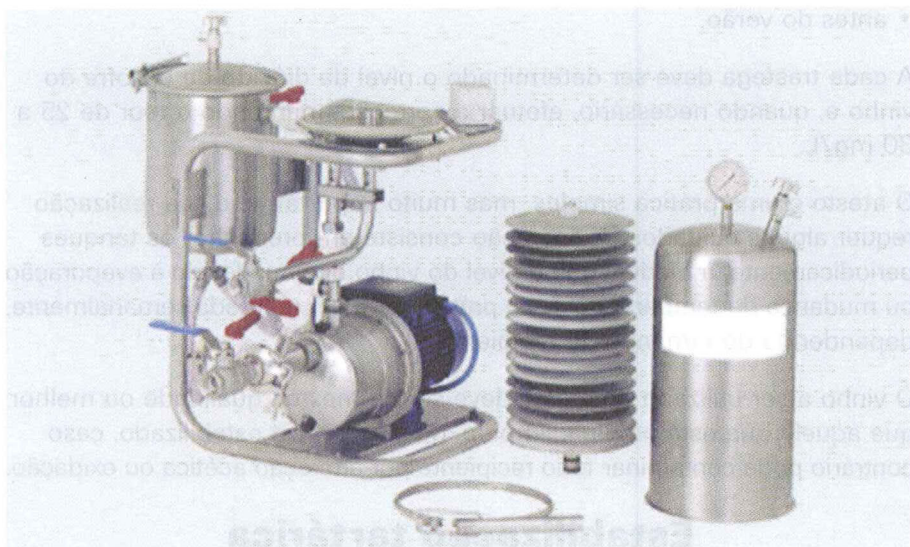
Fig. 6. Filtro à terra utilizado para preparação antes do engarrafamento do vinho tinto.
