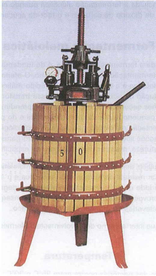
Fig. 5. Prensa vertical descontínua utilizada para prensagem do bagaço na descuba.
